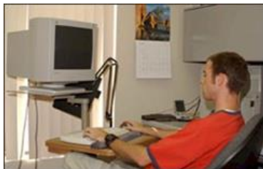
Nepravilno postavljen monitor
